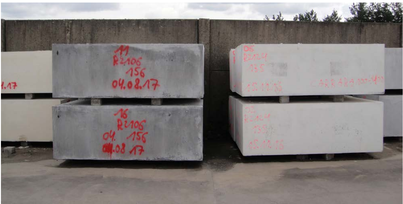
Abb. 97 Betonblocklager für die Herstellung von Betonwerksteinprodukten
