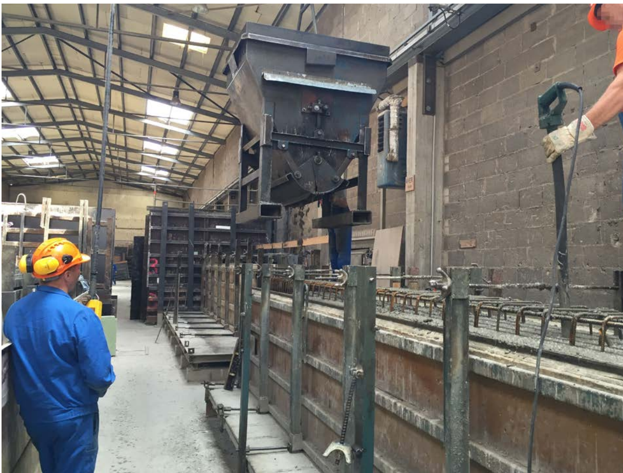
Abb. 104 Betonkübel am Kran
