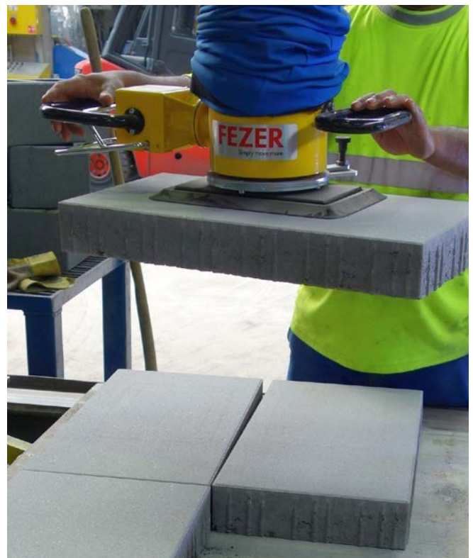
Abb. 62 Einsatz von Hebehilfen
