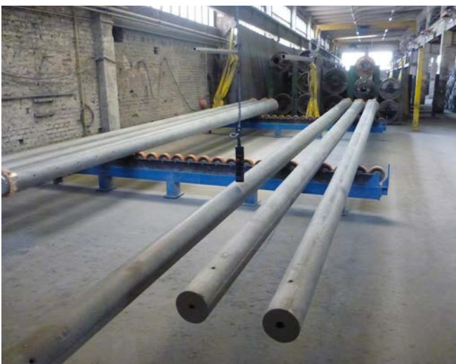
Abb. 93 sichere Lagerung von Schleuderbetonfertigteilen
