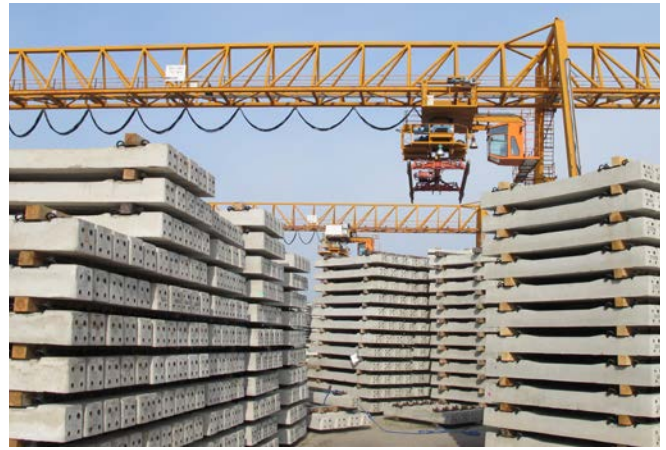
Abb. 79 Lagerplatz für die Betonschwellen
