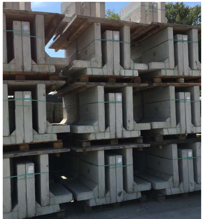
Abb. 112 Lagerung von Winkelstützen
