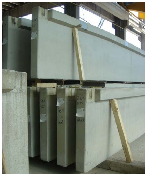
Abb. 34 Negativbeispiel für die Lagerung von Betonfertigteilen
