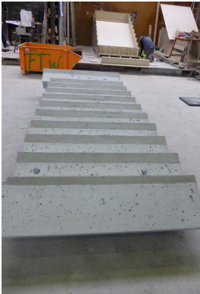
Abb. 4 Treppenlauf als Betonfertigteil
