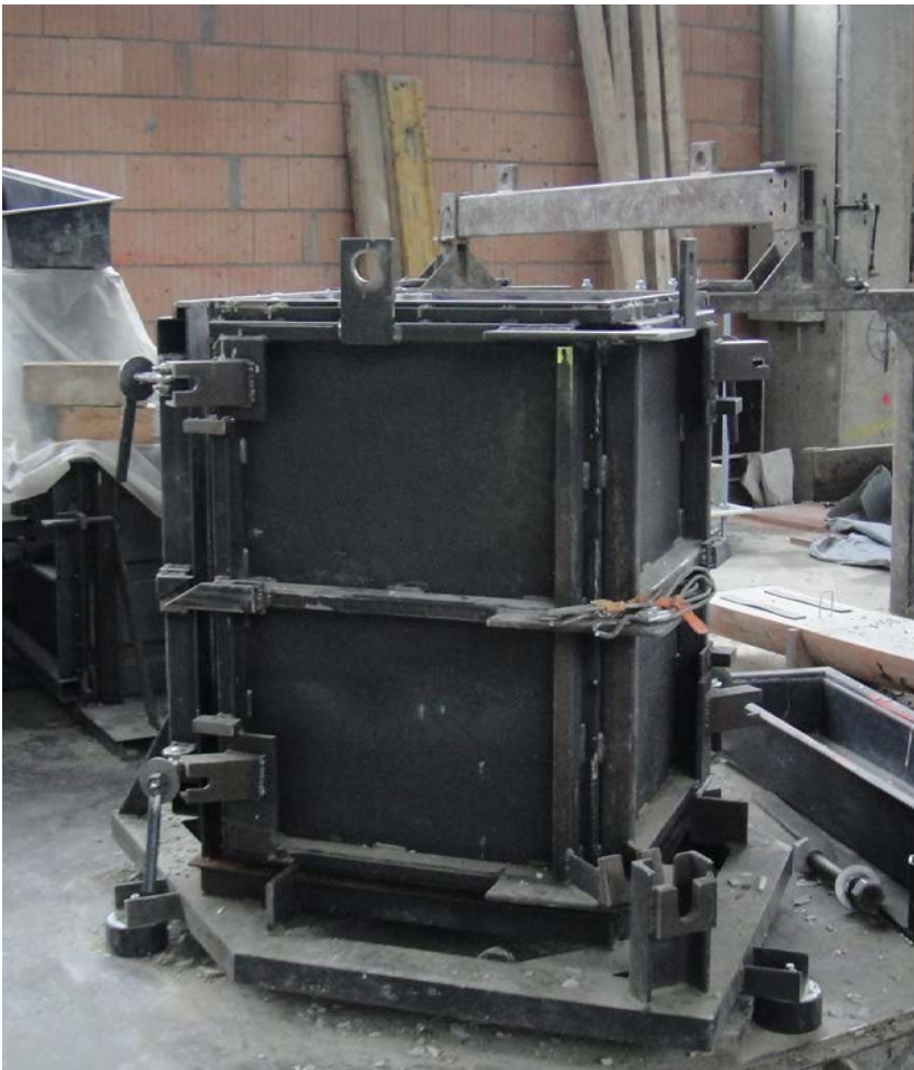
Abb. 94 Schalung für Betonsonderteil
